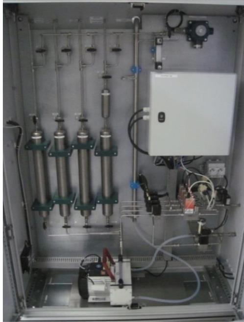
Figure 40. Système régulateur et mélangeur de gaz réceptionné en 2012. Ce système comporte plusieurs voies d'entrée avec des filtres pour purifier les gaz et des débitmètres pour gérer la composition du mélange gazeux. La voie de sortie est composée d'une vanne permettant de réguler la pression et d'une pompe pour éjecter le gaz vers l'extérieur. Chaque élément est détaillé dans les Figure 41 et Figure 42.
