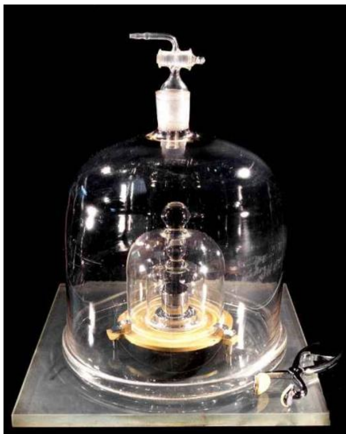
Figure 6. Prototype du kilogramme, étalon primaire détenu au BIPM [11] : une masse cylindrique composée d'un alliage de platine et d'iridium, conservée sous trois cloches de verre.
