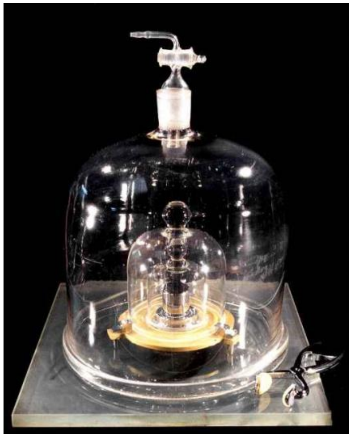
Figure 6. Prototype du kilogramme, étalon primaire détenu au BIPM [11] : une masse cylindrique composée d'un alliage de platine et d'iridium, conservée sous trois cloches de verre.
