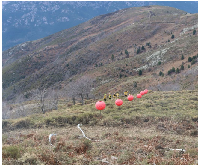
Figure III-9. Positionnement des piquets servant pour la détermination de la vitesse de propagation du front de flammes
