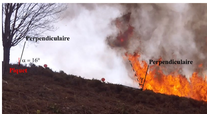
Figure V-18. Estimation visuelle de l'angle d'inclinaison de la flamme (Letia Mars 2022)
