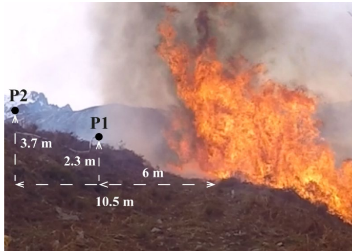
Figure V-10. Positions des fluxmètres radiatifs et totaux par rapport à l'extrémité de la parcelle (Letia Mars 2022)
