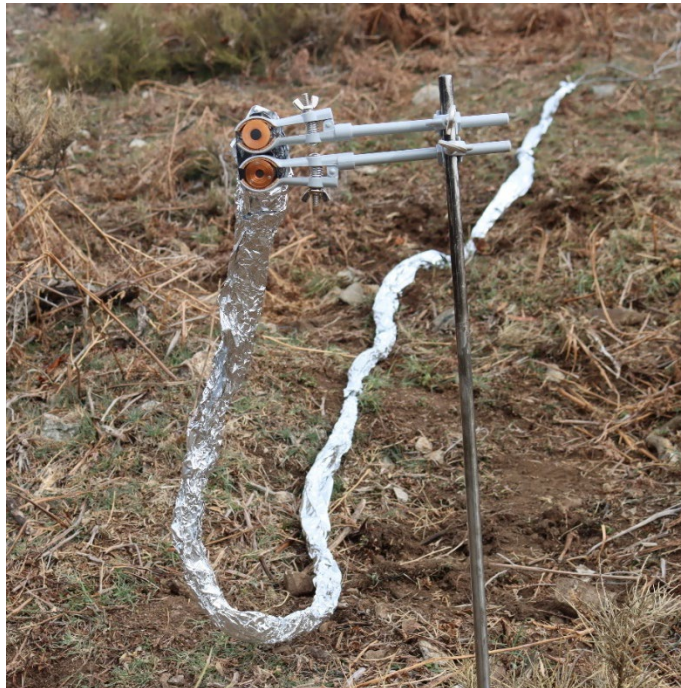
Figure III-10. Capteurs de flux radiatifs et totaux fixés sur des supports et protégés par des feuilles d'aluminium
