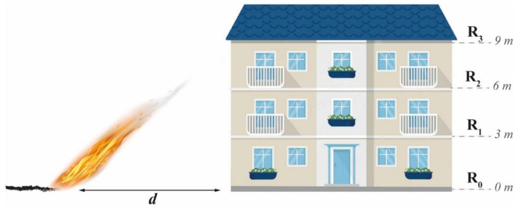
**Figure VI-15.** Configuration de la cible "bâtiment" par rapport à la position du front de flammes
