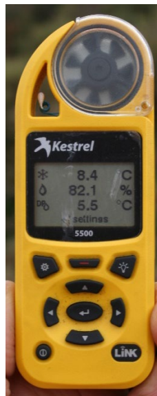
Figure III-8. Station météo (Kestrel 5500)
