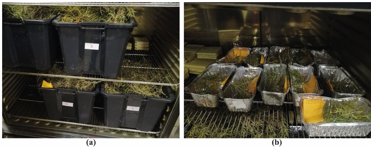
Figure III-5. Séchage des échantillons dans l'étuve pour l'évaluation de : (a) la charge surfacique, (b) la teneur en eau
