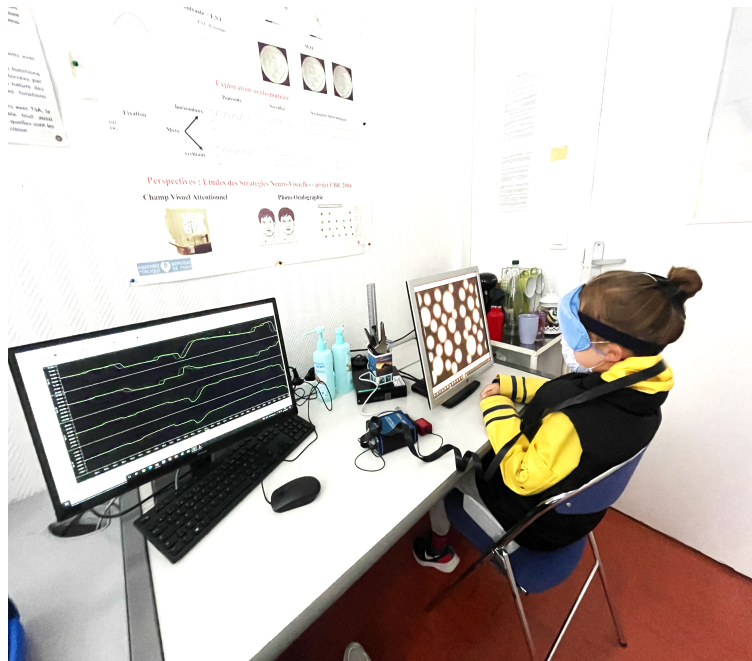
Figure 37: Dispositif d'enregistrement oculométrique du nystagmus optocinétique binoculaire.
