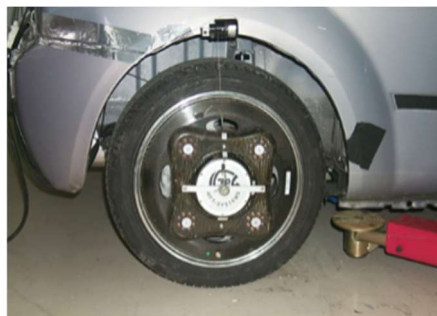
Figure 28 : Roue dynamométrique installée sur un véhicule témoin en atelier
