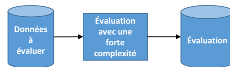
(a) Paradigme standard de calcul de métrique : un algorithme, potentiellement de complexité quadratique, calcule la métrique.
