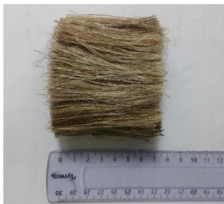
**Figure II. 3** : Fibres de lin de 7cm de longueur
