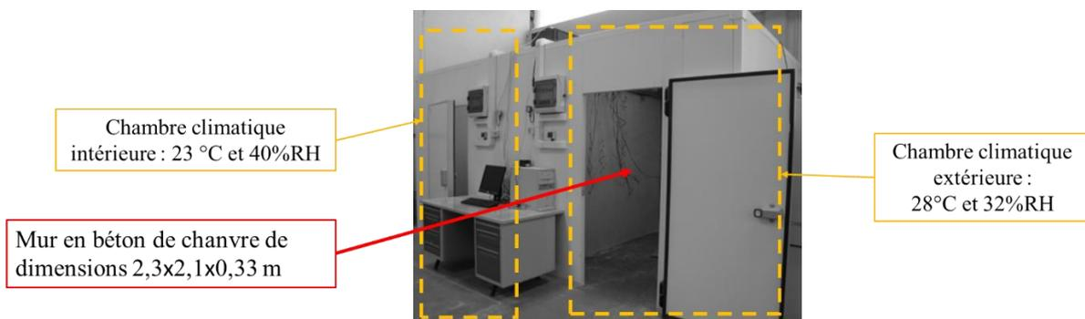
Figure I. 18 : Enceintes climatiques de couplage hydrothermique [Collet & Prerot, 2014]
