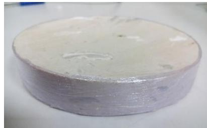
**Figure IV. 11 :** Echantillon de « Cématerre » pour l'essai de transfert de vapeur d'eau
