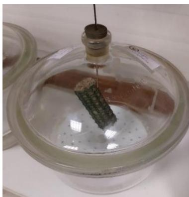
**Figure III. 1 :** Essai d'isotherme d'adsorption des fibres de lin
