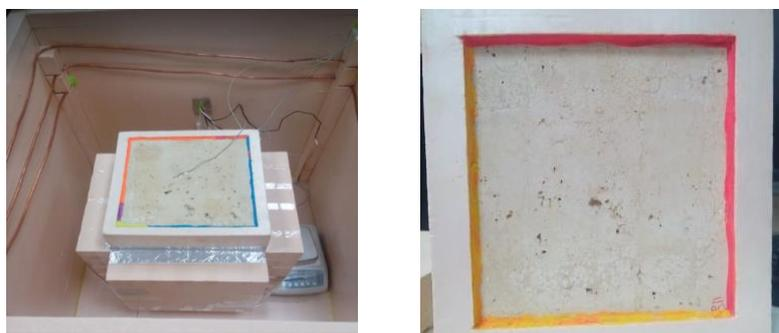
**Figure IV. 7 :** Essai de transfert de chaleur en régime permanent à travers le béton de terre « Cématerre » de dimensions 270×270×60 mm<sup>3</sup>
