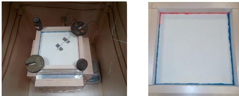
**Figure IV. 10 :** Essai de transfert thermique à travers le plâtre plein à l'aide du dispositif de couplage. Les résultats obtenus sont résumés dans le **Tableau IV. 6**. Les ratios entre la valeur de la fiche technique et celles de cette étude sont entre 0.83 et 0.93.
