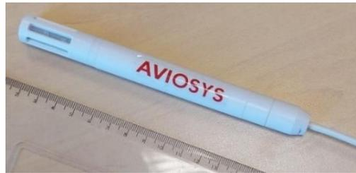
Figure IV. 2 : Sonde de mesure de l'humidité relative des type "AVIOSYS"
