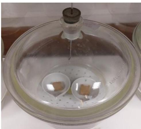
**Figure III. 14 :** Essai d'isotherme d'adsorption des fibres de lin
