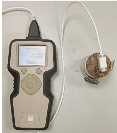
Figure III. 4 : Essai de mesure des propriétés thermiques des fibres de lin
