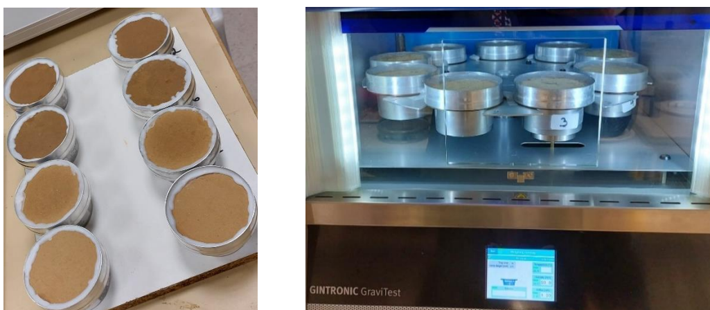
Figure III. 22 : Echantillons en différentes teneurs en eau pour l'essai de mesure de la perméabilité à la vapeur à l'aide de « Gravitest »
