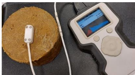
Figure III. 38 : Mesure de la conductivité thermique de la terre crue-fibres de lin à l'aide du dispositif « Tempos Meter »
