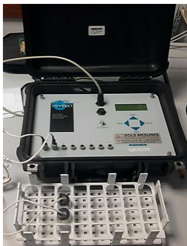
Figure A4. 9 : Etalonnage des sondes psychrométriques à l'aide des solutions de NaCl
