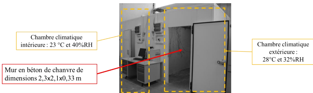
Figure I. 18 : Enceintes climatiques de couplage hydrothermique [Collet & Prerot, 2014]
