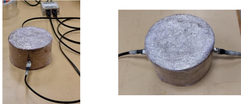
Figure IV. 13 : Capteur SHT40 insérés dans l'échantillon de terre
