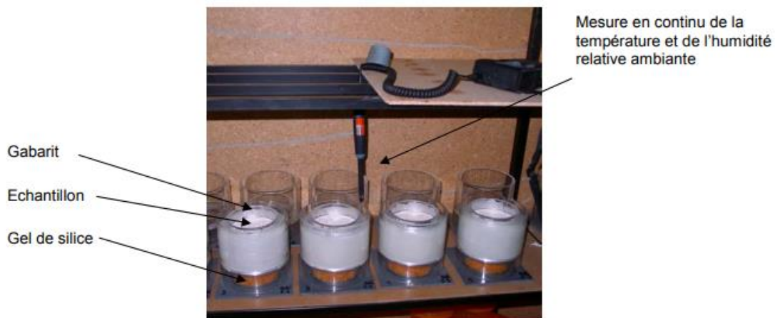
Figure I. 30 : Banc de mesure de la perméabilité à la vapeur de la laine de chanvre [Collet, 2004]
