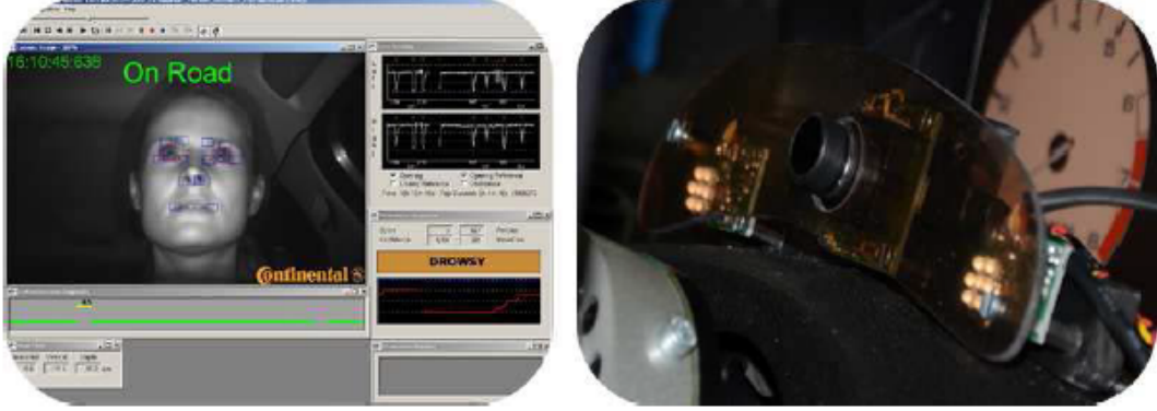
FIGURE 3.6 – Système de Surveillance du Conducteur (DMS).
