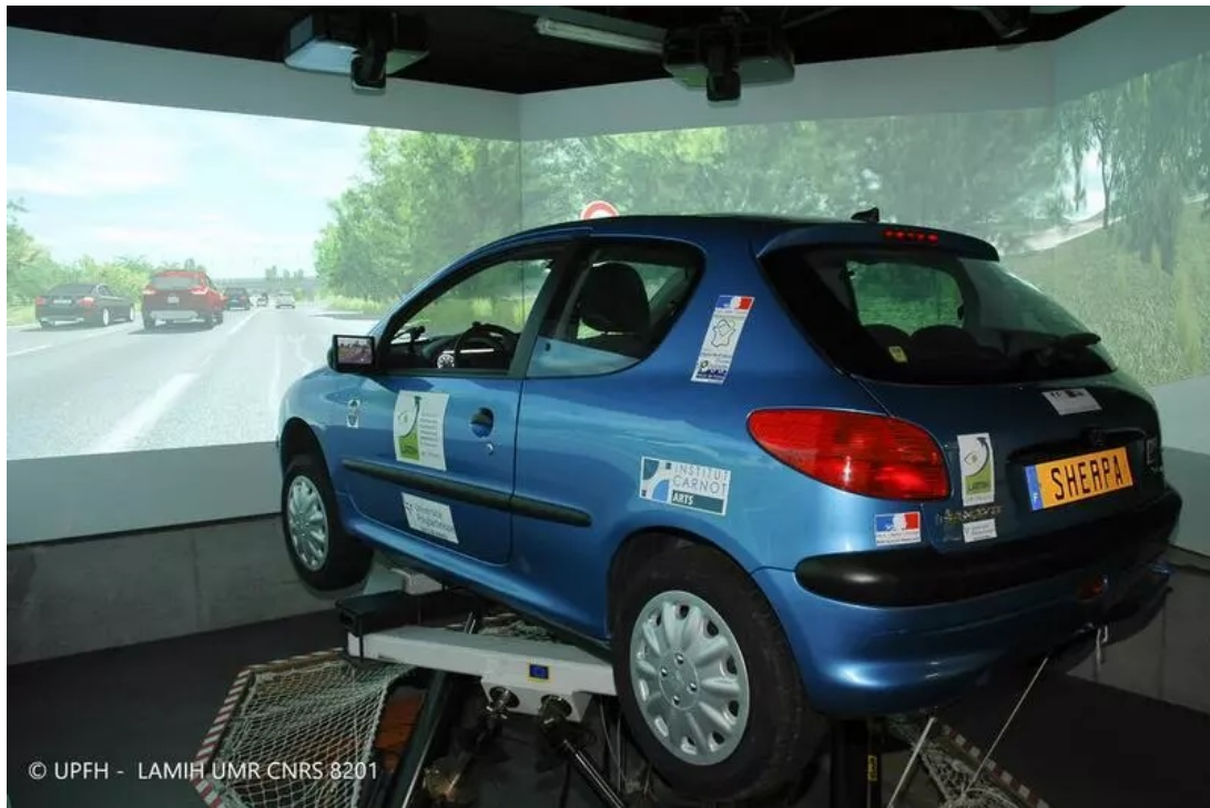
FIGURE 1.13 – Le simulateur de conduite SHERPA-LAMIH.
