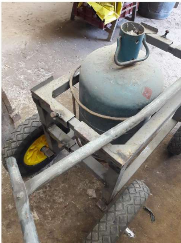
Illustration 16 « Désherbeur à gaz » développé par un maraîcher
