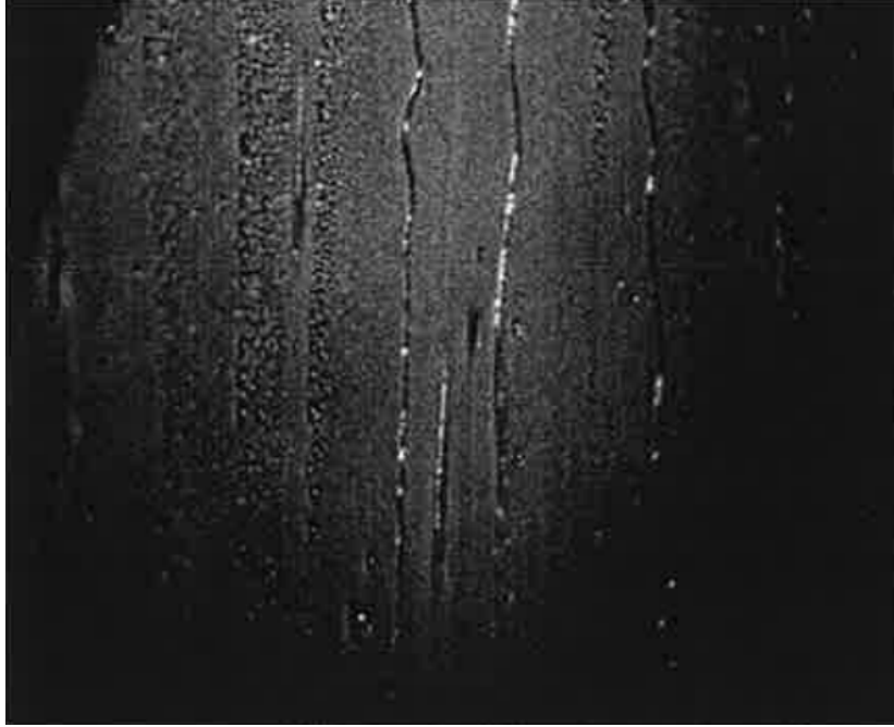
FIGURE 5.50 : Photographie du film liquide prise lors des essais COPAIN (Bazin and Castelli, 1999).
