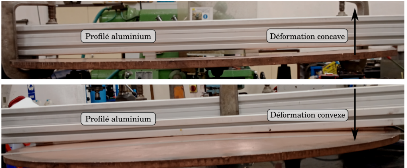
FIGURE 3.2 – Disque sous contrainte mécanique et prêt à être chauffé pour faire une correction de planéité.
