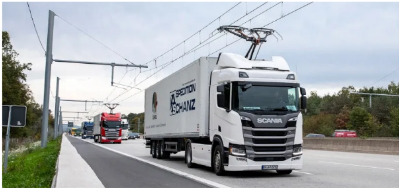
FIGURE 1.3 – Camions à pantographe sur une voie d'autoroute équipée d'une caténaire. Photo extraite d'une communication de Siemens [2].
