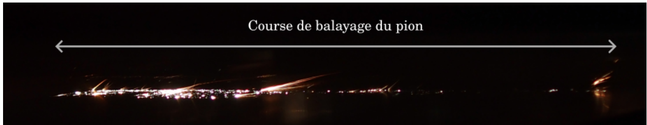
FIGURE 4.26 – Exemple d'une photo, prise dans le noir pour un temps d'exposition de 25 s ( F_N=60 N, I=120 A, v_b=8 mm·s -1 , k=4 N·mm -1 et v_l=60 km·h -1 ).
