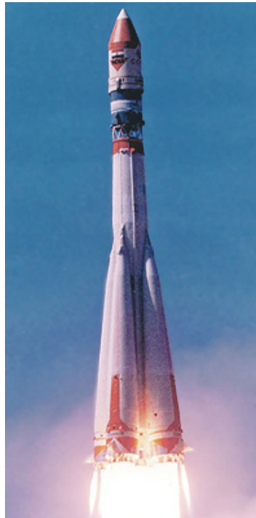
Figure 1.5 – Photographie du décollage d’une fusée Vostok-2M (29 août 1991 - Baïkonour). Le Block E est le second étage identifié par les deux bandes grises au-dessus de la structure inter-étage en croisillon. Source : Roscosmos
