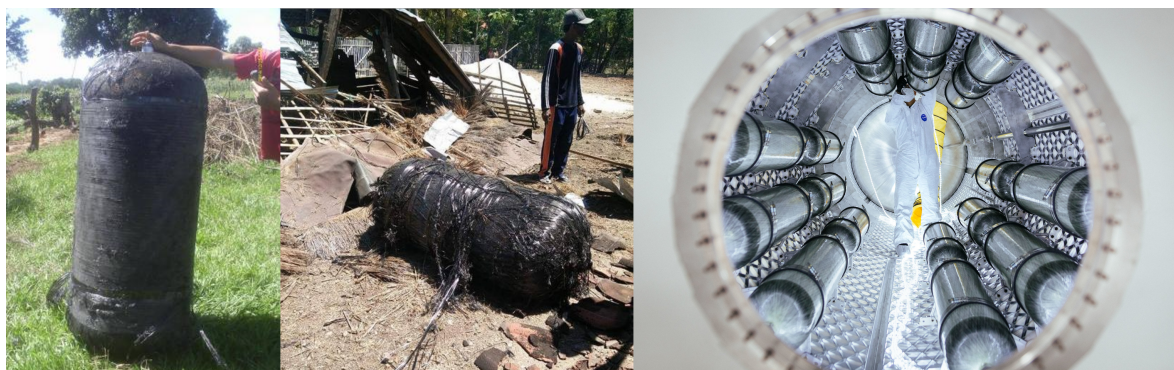
FIGURE 1.7 – COPV retrouvés au Brésil en 2014 et en Indonésie en 2016 appartenant probablement au second étage d’une fusée Falcon 9. Vue intérieur du réservoir du premier étage, contenant 18 COPV, de la fusée RS1 de ABL Space Systems. Source : ESA & ABL Space Systems
