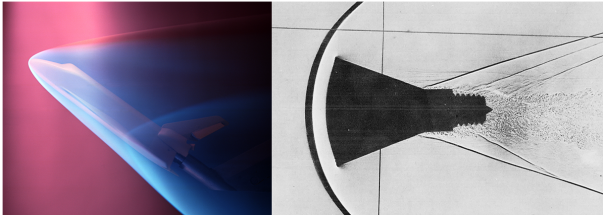
FIGURE 2.12 – À gauche : Photographie de l'écoulement autour de la navette spatiale illuminé par un canon à électron à Mach 20 dans la soufflerie à hélium 22-inch du Langley Research Center de la NASA. À droite : Image Schlieren de l'écoulement autour d'une capsule Mercury à Mach 3,28 par Compton et al. [88].
