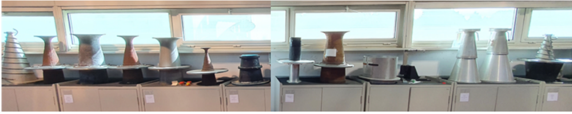
FIGURE 4.5 – Composition photographique de quelques tuyères disponibles pour la soufflerie.
