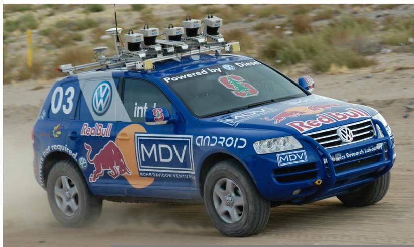
Figure 5: La voiture gagnante du défi DARPA de l'Université Stanford, qui a été la première à intégrer des modèles d'apprentissage automatique pour la conduite. Source: herox.com
