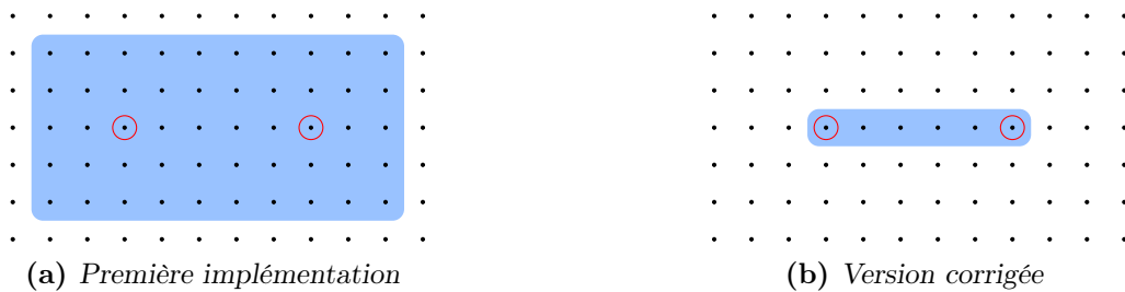
FIGURE 4.11 – Points fins impliqués dans le calcul du flux de chaleur entre deux points grossiers, dans la première implémentation de la méthode à deux grilles et dans sa version corrigée.
