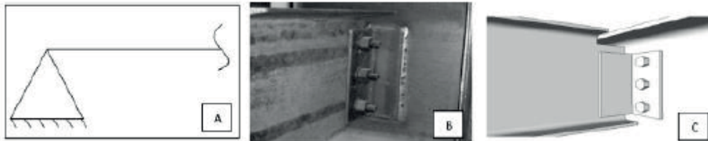
Figure 36 - Illustration des méthodes d'apprentissage des structures à travers A : schémas en deux dimensions, B : photos, maquettes physiques et C : maquettes numériques (Clevenger et al., 2012)
