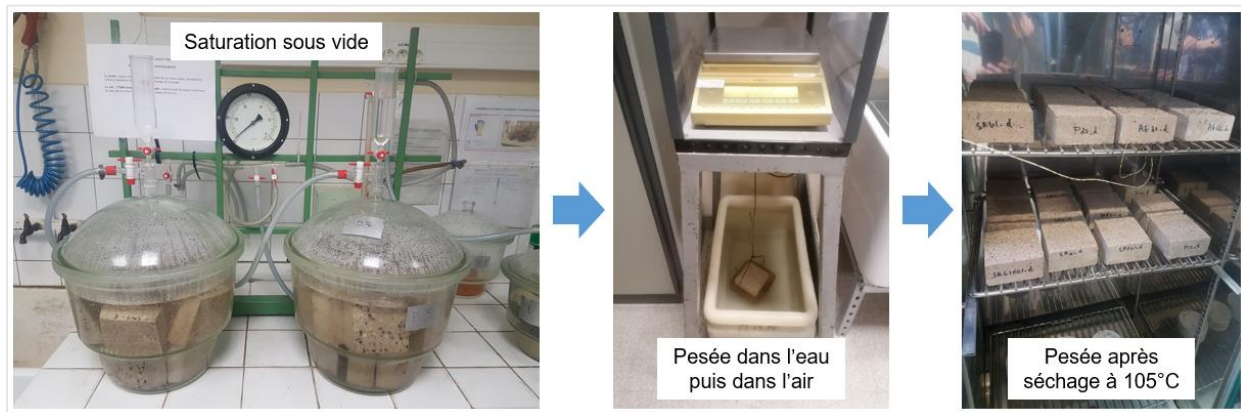
Figure II.6. Montage expérimental d'essai de porosité ouverte et masses volumiques
