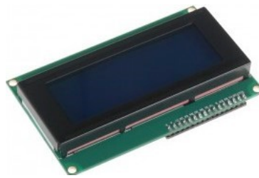
FIGURE 5.10 – Module d'affichage LCD 4*20 caractères.
