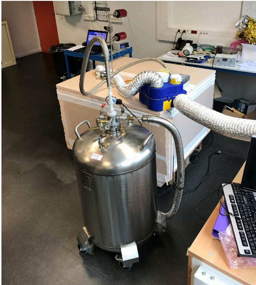
Figure A7.3 - Tests de fonctionnement de la pompe à transfert volumétrique à vis disposée dans une enceinte hermétique convective faite de panneaux de polystyrène. L'enceinte est remplie à une pression d'un bar régulièrement, par l'injection de N 2 cryogénique (liquide) et vidangée via une VMC.
