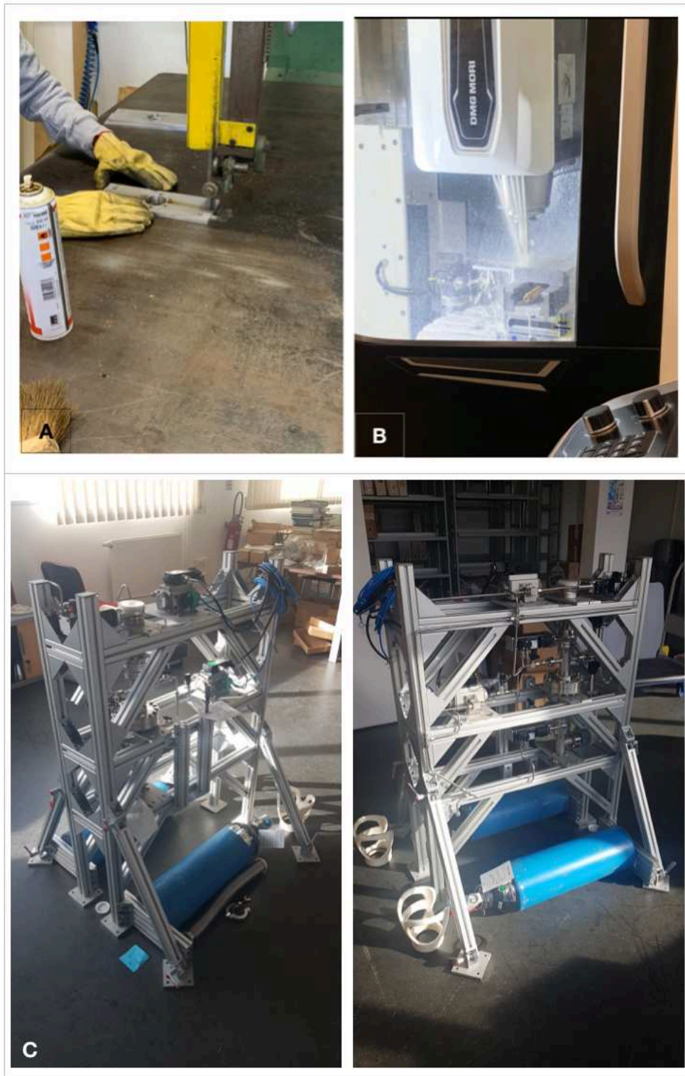
Figure 58 - (A) : Découpage des plaques de maintien en aluminium à l'aide d'une scie à ruban. (B) : Redimensionnement des plaques de maintien en aluminium à l'aide d'une machine CM360 à commande numérique. (C) : Première version assemblée de l'instrument Stratopart (manque le système de pompage).
