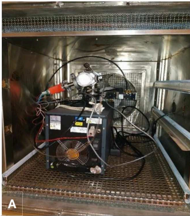
Figure A7.1 - (A) : Montage des essais de la pompe multi-roots (Edwards-vacuum) dans une des enceintes climatiques de la PIT. Le montage comprend une jauge de pression (vérifiant le régime de pompage de la pompe au cours des tests), un système comprenant une membrane filtrante (en quartz) et d'une vanne à guillotine électro-pneumatique (fournisseur VAT). (B) : Bride à vide avec plug-in usinés et soudés pour les parties contrôle et commande de différents éléments du montage.
