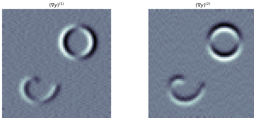
FIGURE 4.2 Les deux composantes du gradient y = \nabla g constituent la quantité pertinente pour le terme d'attache aux données de (Q_\alpha(y)) . Notez que le bruit sur l'image a un effet d'autant plus grand sur le gradient, de sorte qu'une stratégie de débruitage du gradient doit être adoptée, en particulier pour les images expérimentales.
