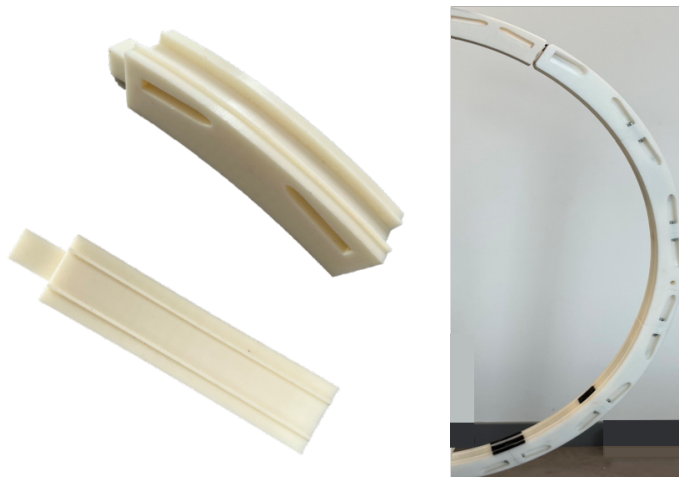
FIGURE 4.13 – Arc en demi-cercle réalisé par fabrication additive
