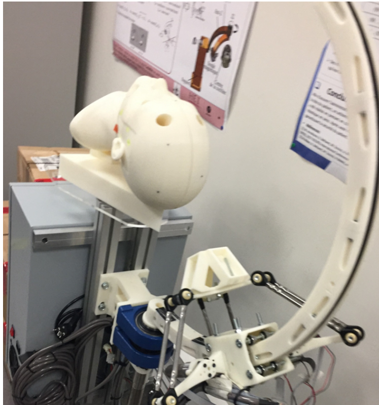
FIGURE 4.14 – Second prototype du robot porte-effecteur magnétique réalisé par fabrication additive. On distingue le coulisseau portant la partie Delta et guidé sur l'arc en demi-cercle
