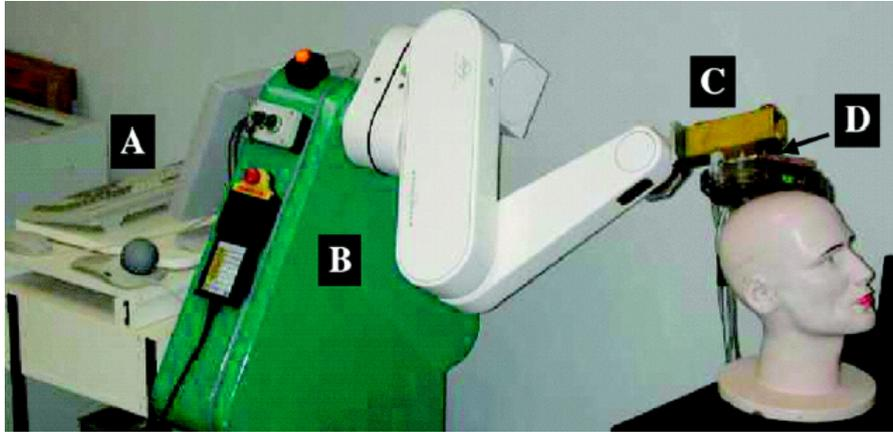
FIGURE 1.15 – Système robotique pour la SMT proposé par Lancaster et al. [Lancaster *et al.*, 2004]
