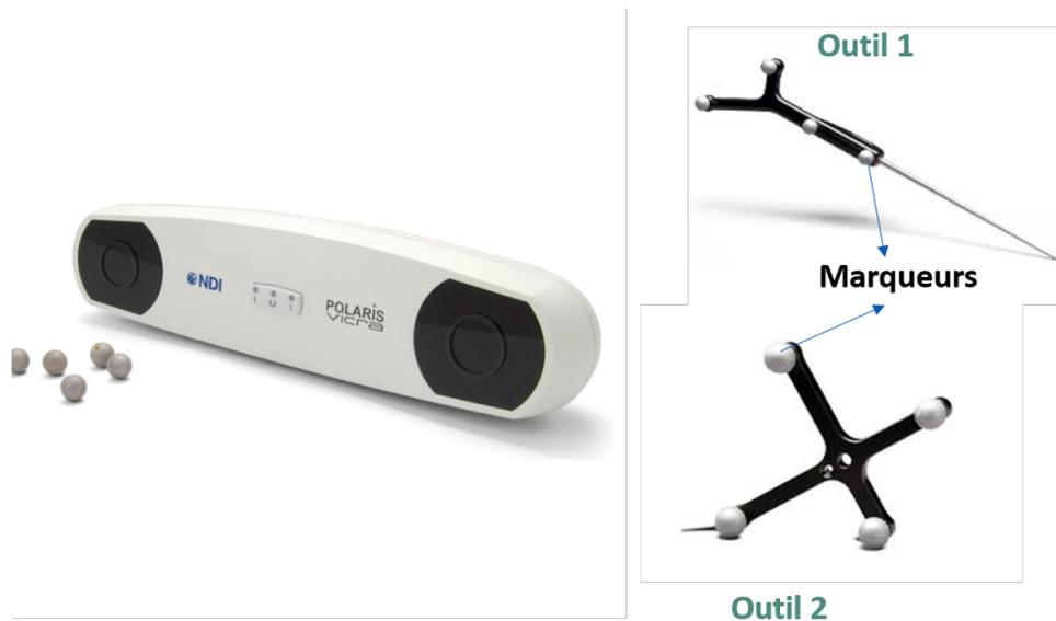
FIGURE 4.23 – Le “trackeur optique” *Polaris Vicra* (Northern Digital Inc.); à droite : les instruments à marqueurs passifs utilisés
