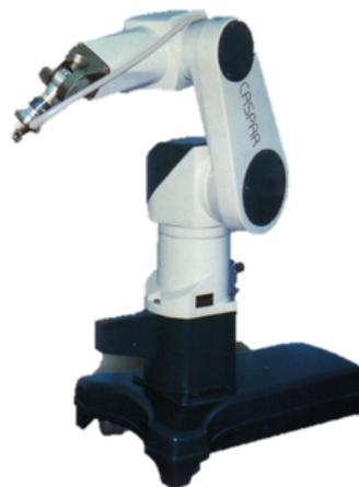
FIGURE 1.18 – Robot Capsar utilisé en chirurgie osseuse et articulaire, *Ortomaquet*
