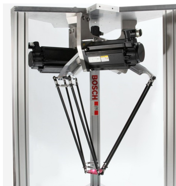
FIGURE 1.29 – Le robot parallèle de type Delta [Clavel, 1987]
