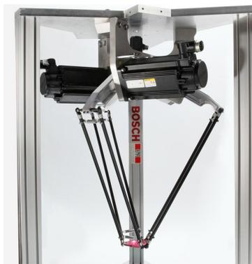
FIGURE 1.29 – Le robot parallèle de type Delta [Clavel, 1987]
