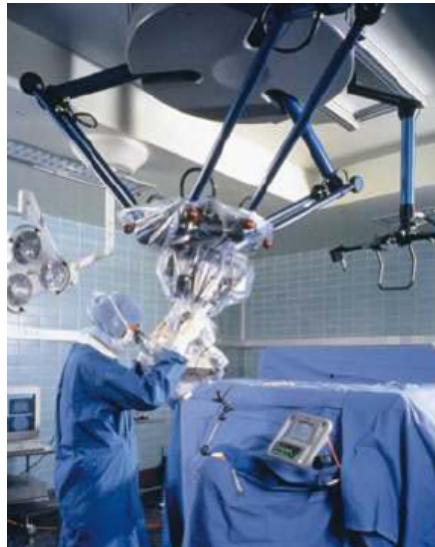
FIGURE 1.30 – Le robot parallèle de type Delta SurgiScope, en salle d'opération
