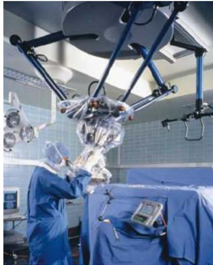
FIGURE 1.30 – Le robot parallèle de type Delta SurgiScope, en salle d'opération
