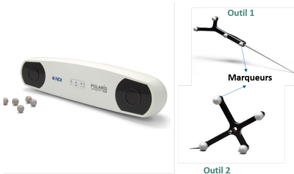
FIGURE 4.23 – Le “trackeur optique” Polaris Vicra (Northern Digital Inc.); à droite : les instruments à marqueurs passifs utilisés
