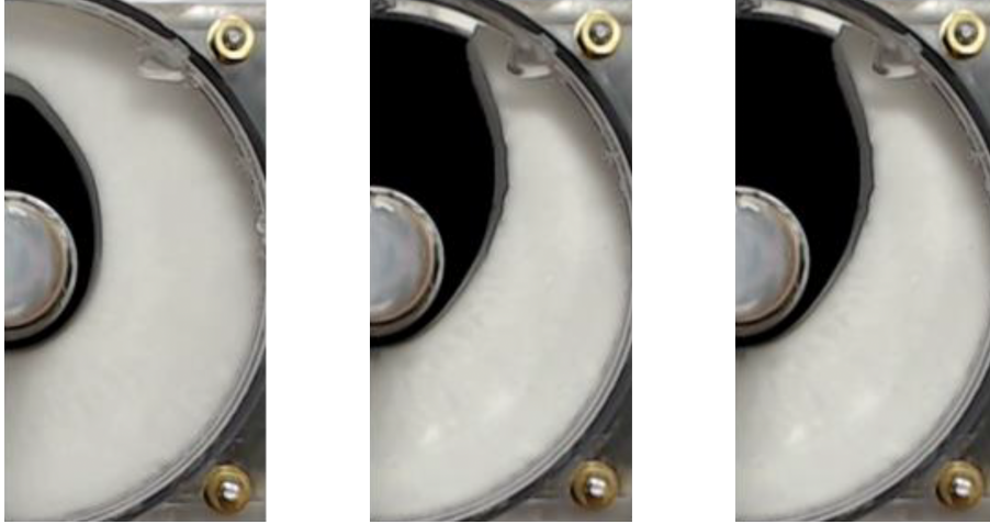
FIGURE 1.2. – Observations expérimentales de la fusion du n-octadécane dans un domaine cylindrique, chauffé par une cylindre interne (Azad and Groulx, 2021).
