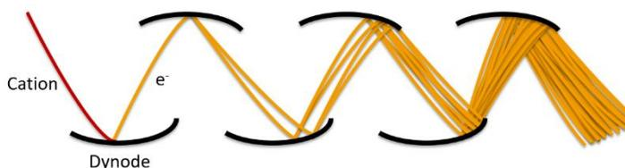
Figure 16 : Schéma d'un multiplicateur d'électrons à dynodes.
