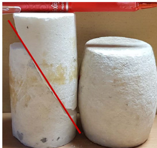
FIGURE 3.3 – Différents types de rupture [106]
