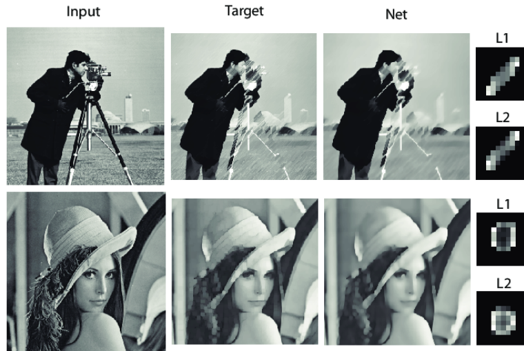
FIGURE 2.13 – Exemple d’apprentissage d’un opérateur de fermeture (élément structurant ligne de longueur 10 orienté à 45^\circ ) et d’ouverture (élément structurant carré de côté 5). Les noyaux L1 et L2 représentent l’état des poids des couches 1 et 2. [Masci et al., 2013].
