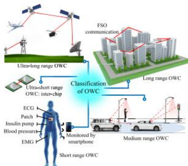
Figure I-1 : Exemple de classification de systèmes OWC selon la portée [17]
