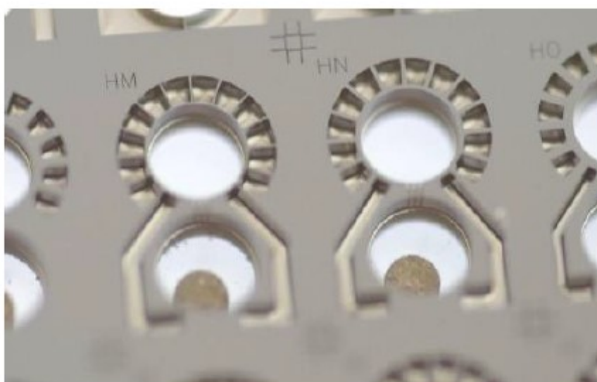
FIGURE 3.29 – Cellules à réservoirs multiples pour réaliser un mélange de gaz Ne-He dont le ratio est contrôlé.
