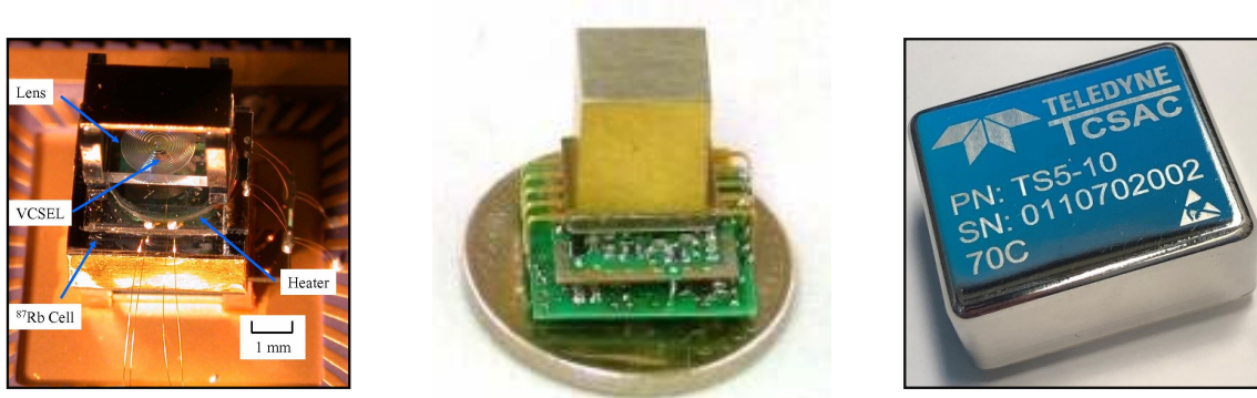
FIGURE 1.31 – Module physique de la micro-horloge atomique CPT commerciale proposée par l'industriel Américain Teledyne [17, 109].
