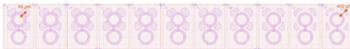
FIGURE 3.26 – Extrait du masque de fabrication des réservoirs avec une épaisseur de membrane en silicium variable (entre 50\ \mu\text{m} et 400\ \mu\text{m} ) et une conception de réservoirs différentes de la configuration précédente.
