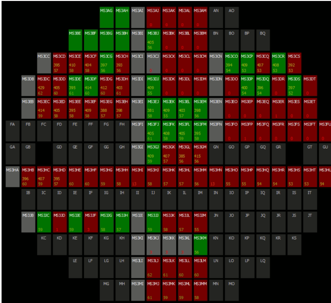
FIGURE 3.40 – Cartographie du wafer avec les cellules cassées identifiées en rouge et celles scellées identifiées en vert.
