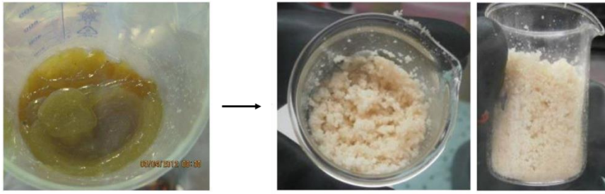
Figure 3 : Huile LOR nommée 75 (haute viscosité) dans le Nochar® selon un rapport huile : polymère de 1:1 en masse. Figure extraite de Vaudey et al. 29
