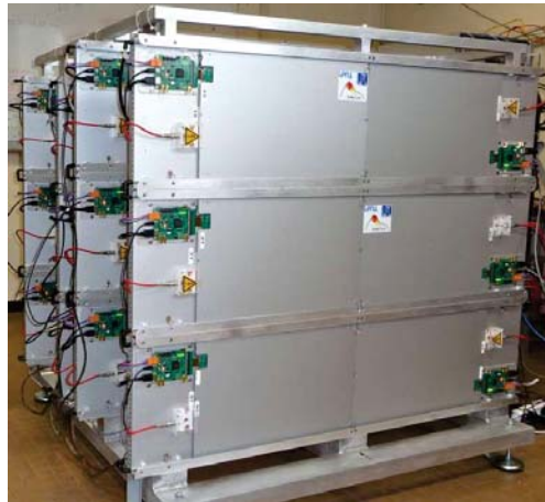
FIGURE 4.3 – Le télescope TOMUVOL était composé de quatre plans de détection de 1 \text{ m}^2 faits de GRPC. La distance entre les plans du télescope pouvait être variée selon la résolution angulaire et l'acceptance géométrique voulues. Cette version du télescope, utilisée sur le site TDF de novembre 2013 à janvier 2014 avait des plans équidistants et une distance de 1 \text{ m} entre les plans extérieurs.
