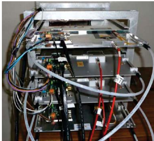
FIGURE 4.13 – Banc d'essai au LPC avec quatre chambres en cours de qualification.
