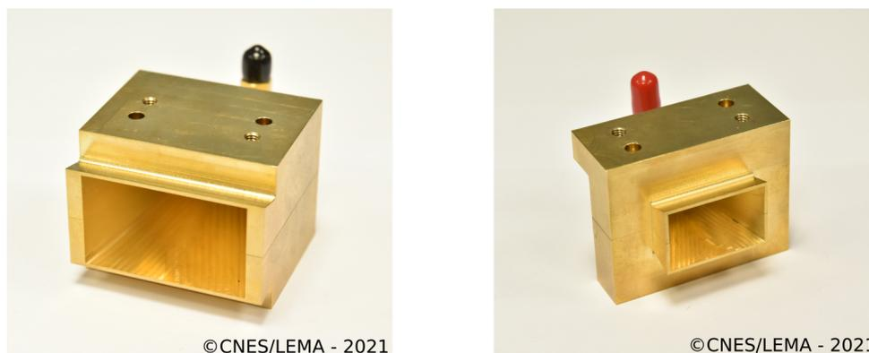
FIGURE 5.6 – Photographies des cornets utilisés pour la mesure. Cornet à la fréquence basse (à gauche) et à la fréquence haute (à droite). Les ports SMA des transitions guide coaxial sont visibles à l'arrière des cornets.
