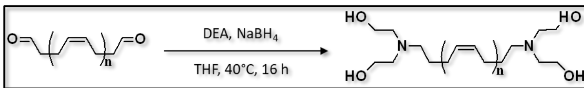
Figure 22 : Fonctionnalisation en bout de chaîne de l'AT-PB
