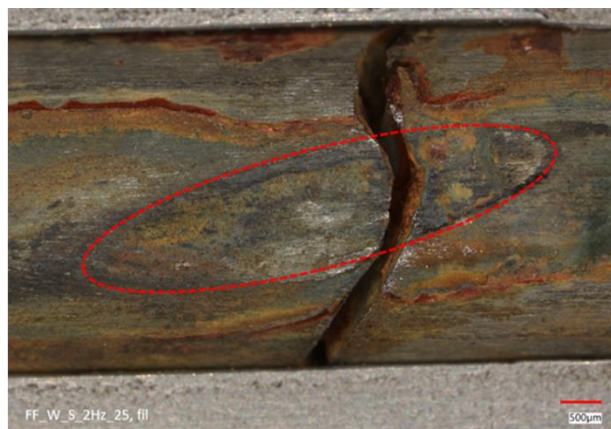
Trace de fretting après essai en eau de mer
