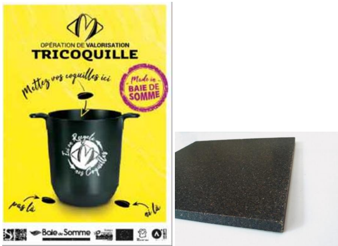
Figure 51 : Gauche : opération de communication auprès des restaurateurs pour la collecte des déchets coquilliers. Droite : exemple de valorisation des coquilles de moules en revêtement de sol. Source : CABS3V, 2019
