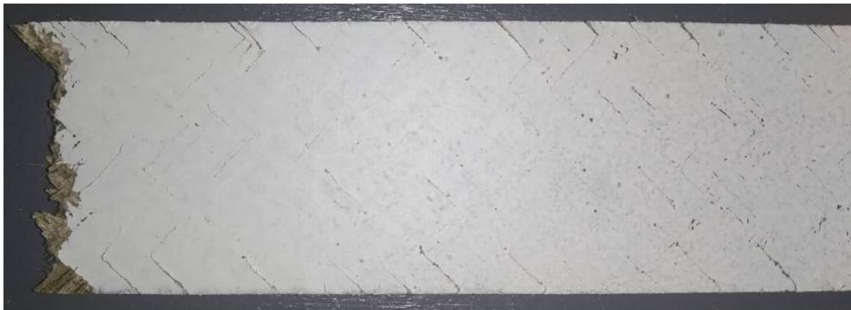
Figure IV-13 : Observation de fissures sur le mouchetis d'une éprouvette sollicitée en traction
