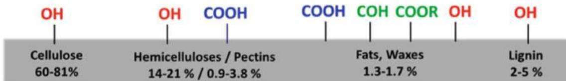
Figure I-32 : Fonctions réactives à la surface des fibres naturelles <sup>47</sup>
