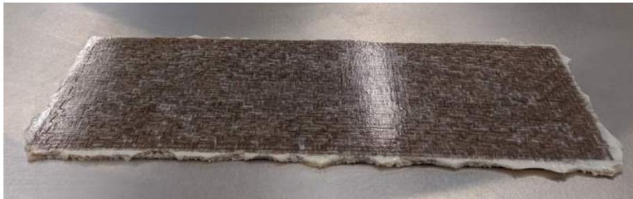
Figure IV-1 : Stratifié Lin/matrice commerciale (4 plis)
