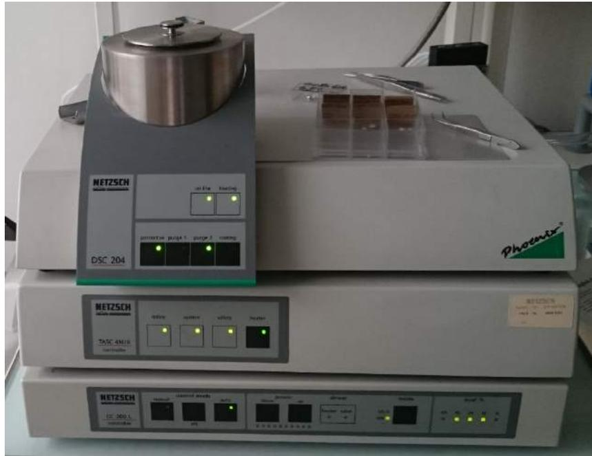
Figure II-11 : Calorimètre à balayage NETZSCH
