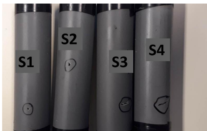
Figure 3.20. Échantillons pour différentes fuites : S1(1 mm), S2(2 mm), S3(4 x 1 mm 2 ), S4(10 x 1 mm 2 )
