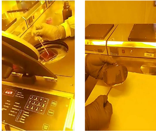
Figure 2.15. Principe de déposition et de séchage de la résine AZ5214 sur la surface du substrat
