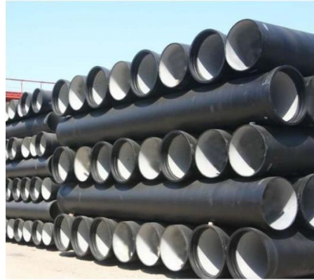
Figure 3.6. Canalisation en fonte ductile
