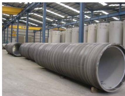
Figure 3.7. Canalisation en béton à âme en tôle
