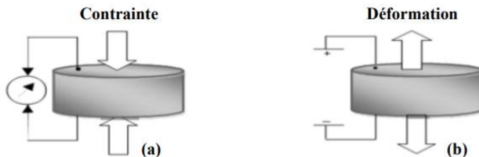
Figure 1.1. Principe de la piézoélectricité
