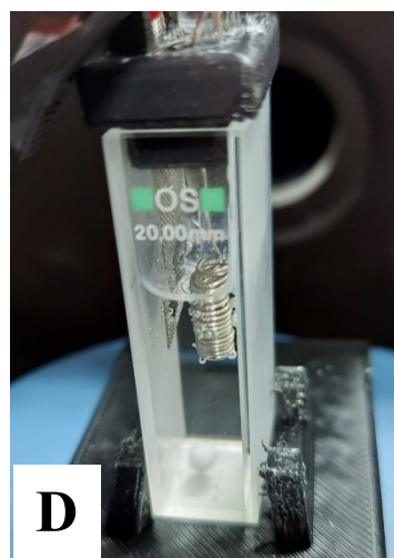
Figure 58 : (a) et (b) Variation de la teneur en AQS dans Mg_2Al-AQS en conditions voltammétrie cyclique (jusqu'à 40 min) et OCP (jusqu'à 19 jours) en fonction du temps ; (c) et (d) coloration de la solution de l'électrolyte en condition (d) Montage UV/visible utilisé pour quantifier la teneur en AQS dans l'électrolyte
