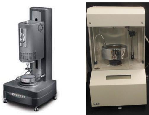
FIGURE 3.8 – Rhéomètre AR-G2 (à gauche) et tensiomètre K12 (à droite).
