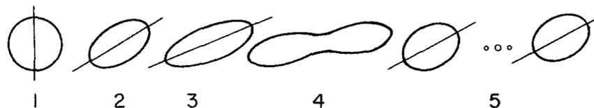
FIGURE 2.20 – Résumé schématique du fractionnement binaire observé par Rumscheidt et Mason [46] dans le cadre d'un écoulement de type cisaillement simple.
