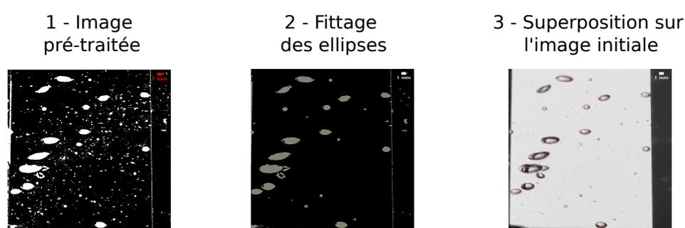
FIGURE 13.12 – Différentes étapes du traitement automatique d’une image issue de l’aération d’eau distillée.
