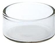
FIGURE 3.7 – Cristallisateur de 25 mL utilisé pour la détermination de la masse volumique.
