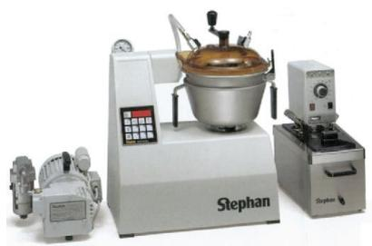
FIGURE 3.5 – Mélangeur Stephan utilisé pour la préparation des solutions modèles.
