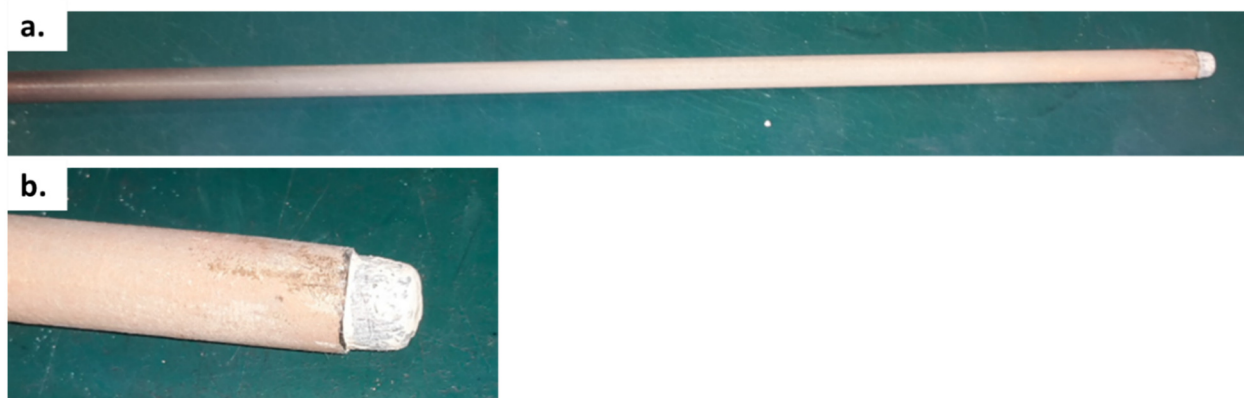
Figure 173. Photographie de la gaine du thermocouple après exposition à une fluoration à 400°C, et zoom sur la pointe de celle-ci.
