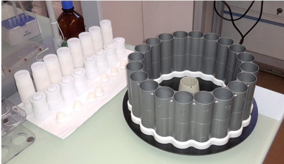
Figure 48. Photographie d'une collection de réacteurs de digestion rangés à côté du plateau \mu -onde.
