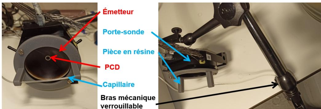
FIGURE 5.8 – Transducteur ultrasonore utilisé dans l'expérience de caractérisation de la cavitation à travers un demi crâne humain. Le transducteur est encastré dans un porte-sonde sur lequel est attaché la pièce en impression 3D permettant de positionner le capillaire dans la tache focale. Le bras mécanique verrouillable est lié au porte-sonde.
