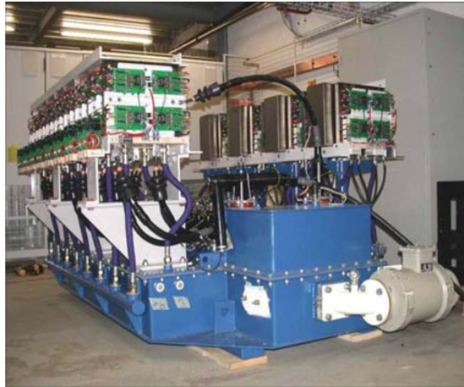
FIGURE 1.18 – Prototype de PETT à structure directe réalisé par ABB [5,9].
