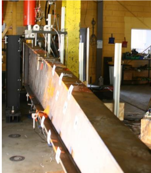
Figure 8 : Ruine de la poutre à section variable et mono-symétrique
