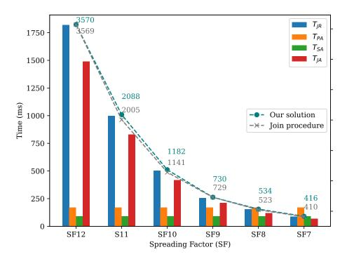
Figure 6: Variation des métriques évaluées en fonction de LoRaWAN SF.
