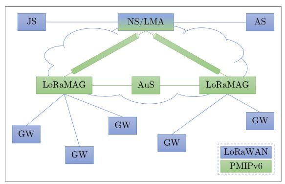
Figure 1: Architecture LoRaWAN évoluée.
