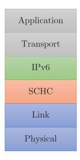
Figure 2: Pile de protocoles de nœud mobile.
