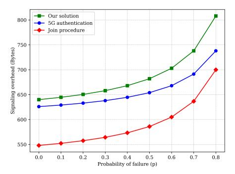
Figure 7: Variation de la surcharge de signalisation des procédures d'accès en fonction de p.
