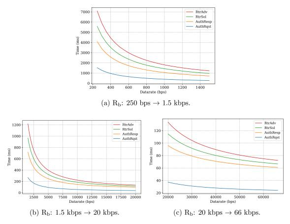
Figure 3: Résultats de la simulation du délai de l'authentification.
