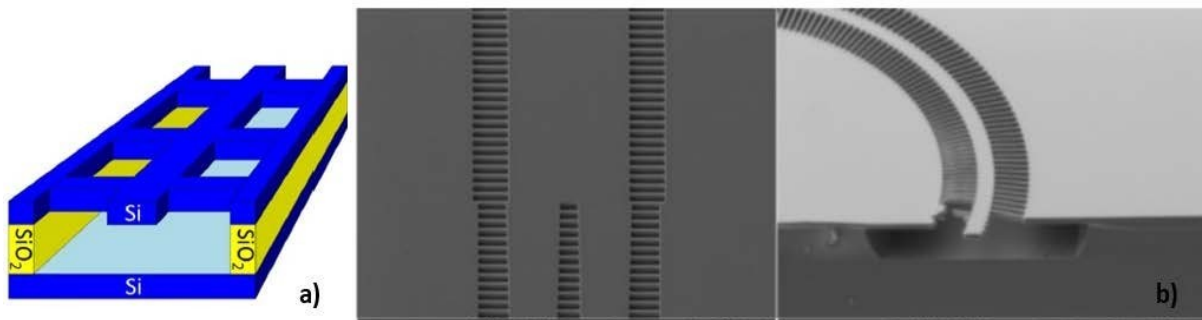
Figure 17 - a) Schéma représentatif d'un guide suspendu (vue 3D). b) Vues MEB d'une section d'un interféromètre multimodes (MMI) (vue de dessus) et d'une facette clivée avec quelques bandes de silicium détruites en raison du clivage [60].
