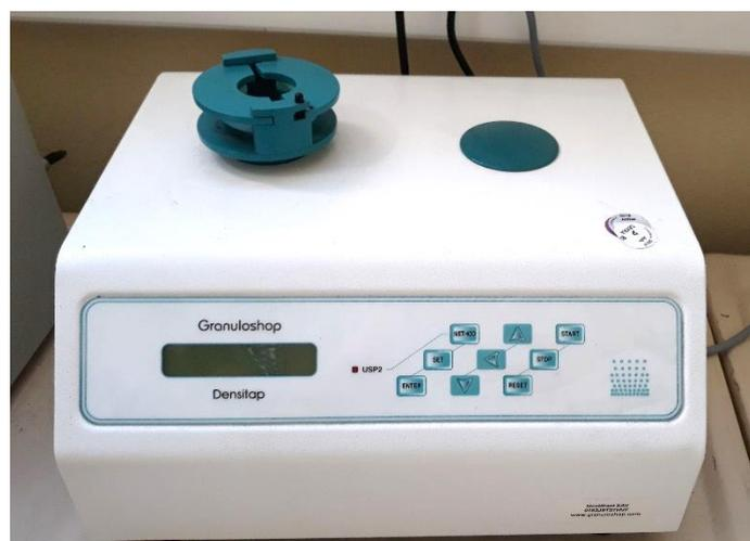
**Figure 2.14** - Dispositif utilisé pour la détermination de la densité tapée – Densitap ETD-20
