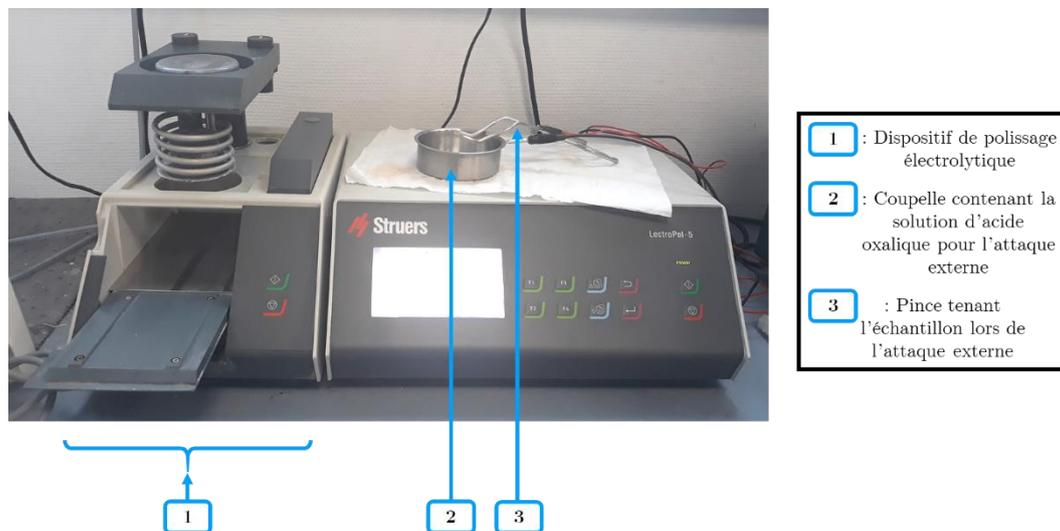
**Figure 2.16** - LectroPol-5 de Struers avec les parties polissage et attaque électrolytiques.
