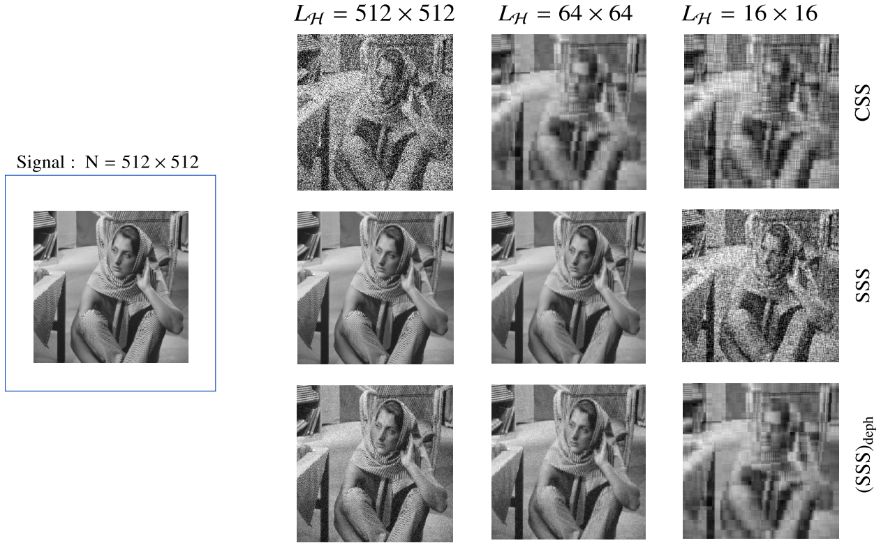
FIGURE 4.4.1 – Exemple de compression d'image avec gain quantique : Un signal 2D (l'image de Barbara) d'une taille N = 512 \times 512 (gauche) est reconstruit (droite) avec \mu = 10 mesures indépendantes pour chacun des premiers L_{\mathcal{H}} \leq N coefficients de Hadamard, les derniers N - L_{\mathcal{H}} coefficients étant considérés comme nuls. Les coefficients non nuls sont estimés avec l'état cohérent de spin (CSS) (en haut), l'état comprimé de spin (SSS) obtenu par la dynamique OAT (2.38) en l'absence de décohérence à l'instant t_{L,\text{best}} (au milieu) et en présence de décohérence par un déphasage diffusif (4.41) avec \gamma = 5\chi (en bas), pour L_{\mathcal{H}} = N = 512 \times 512 , L_{\mathcal{H}} = 128 \times 128 , 64 \times 64 , 32 \times 32 , 16 \times 16 de gauche à droite respectivement.
