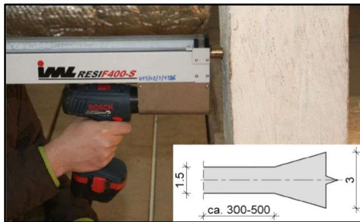
Figure 1.11- Exemple d'utilisation d'un Resistograph® (Nowak et al. , 2016)
