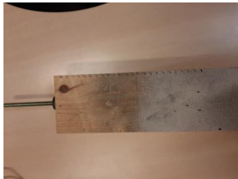
Figure 2.15- Tige métallique dans une section de bois soumise aux mesures radar
