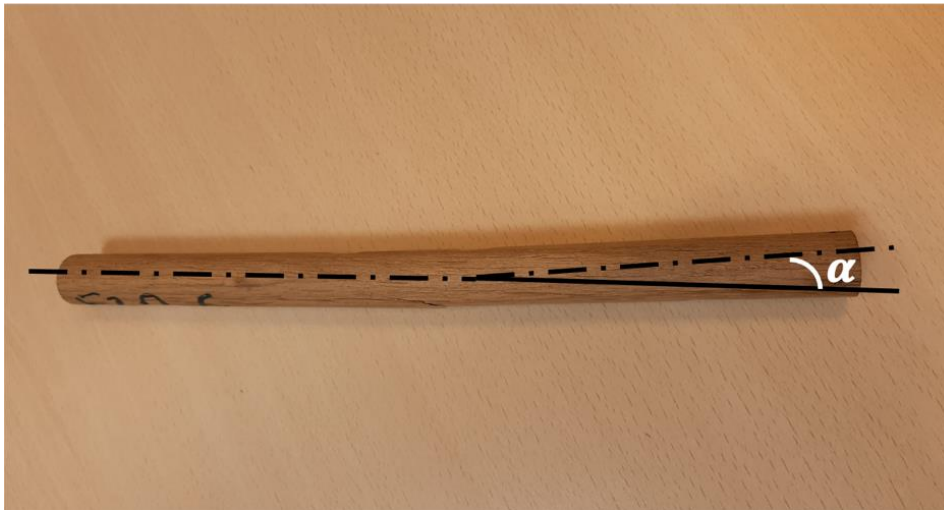
Figure 2.19- Aspect d'une cheville de 20 mm à la fin de l'essai montrant l'angle de rotation \alpha
