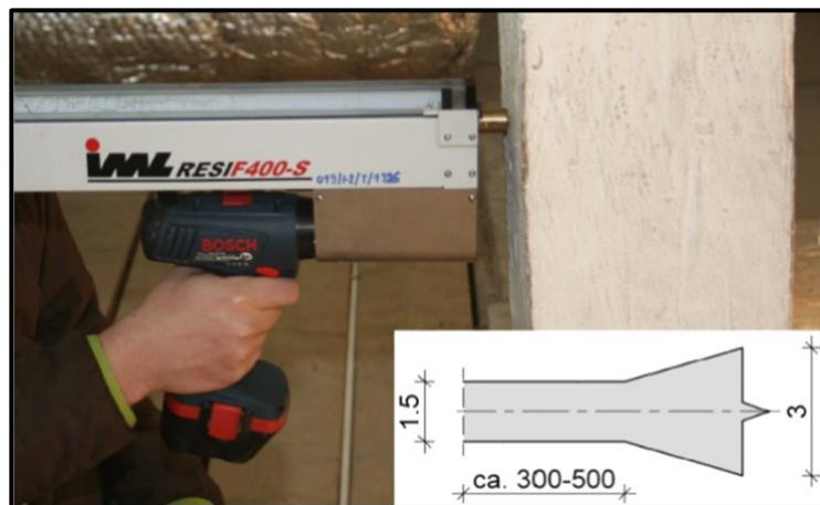
Figure 1.11- Exemple d'utilisation d'un Resistograph® (Nowak et al. , 2016)
