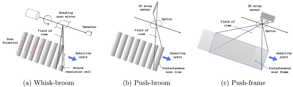
Figure 2.1: Une représentation des différentes technologies d'imagerie satellite, chacune illustrant le détecteur d'une bande spectrale: du balayage pixel par pixel avec la technologie "whisk-broom" (2.1a), au balayage ligne par ligne avec la technologie "push-broom" (2.1b), jusqu'au balayage image par image avec la technologie "push-frame" (2.1c).
